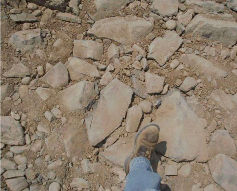
Enrochement colmaté après mise en œuvre et compaction
