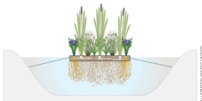
Figure 4 – Vue en coupe d'un marais flottant.
